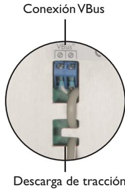
través de una línea de bus conjunto con el regulador y los módulos adicionales.
