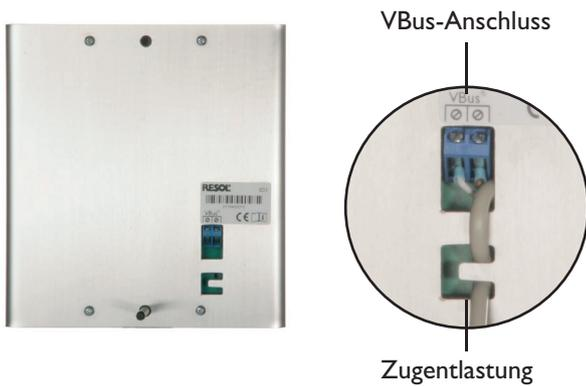
Das Smart Display SD3 kann mit Regler und Zusatzmodulen parallel über eine Busleitung betrieben werden.
