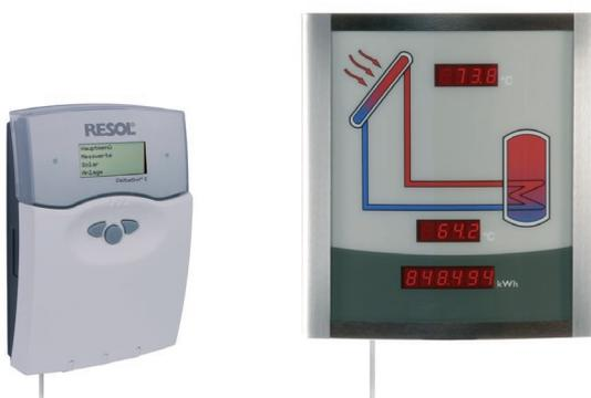
El RESOL Smart Display SD3 está diseñado para que se conecte fácilmente a un regulador RESOL a través del RESOL -VBus®. La línea de bus puede prolongarse con un cable bifilar convencional (cable de timbre). La línea lleva tensión baja y no podrá tenderse junto con otras líneas que lleven más de 50 V en un mismo canal (cumplir las normas VDE y locales). La línea deberá tener una sección mínima de 2 mm² y, en caso de conexión única, puede prolongarse hasta 50 m.
